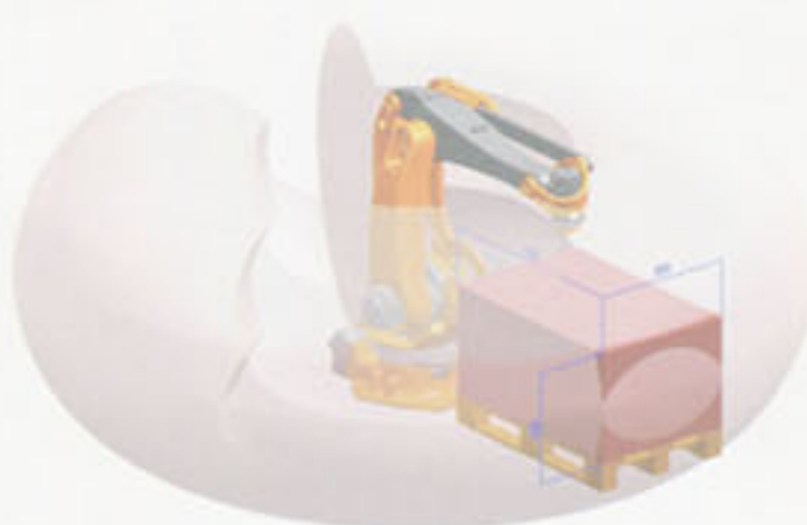
歐式托盤 800 x 1200 mm 最高疊起高度 600 mm
