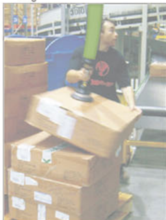
▲ 生產線吊運疊棧作業 Carton
