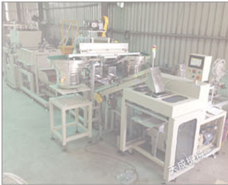
五金件供料磅重裝袋機 Auto Bagging System
