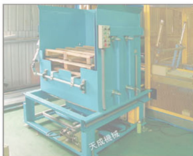
棧板供應機 Empty Pallet Supplier
